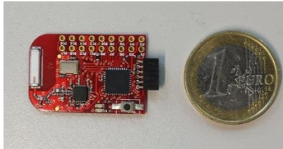
Abbildung 1: Draufsicht auf verwendetes eZ430-RF2500-Entwicklungsboard
