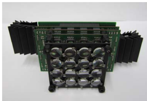
Abbildung 3: Messsystem bestehend aus einem Array von 16 Einzel-Sensoren
